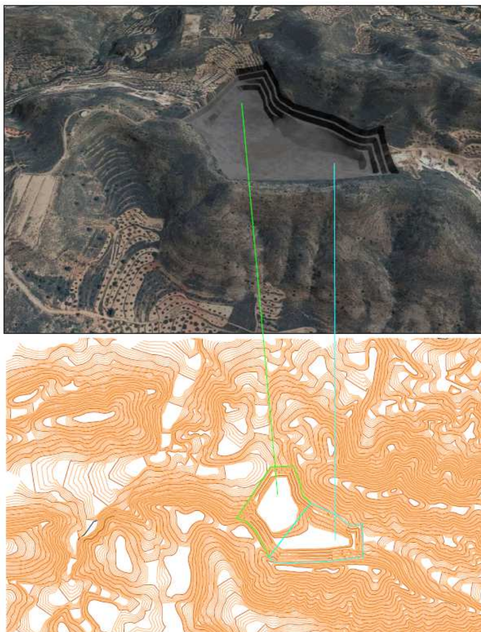
Figura 9. Simulación 3D y curvado de situación del hueco teórico de explotación tras la explotación de la Fase II (en verde) y de la Fase I (en cian).
