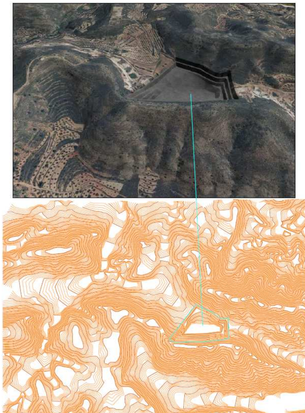
Figura 6. Simulación 3D y curvado de situación tras la Fase I de explotación, donde se puede observar la creación del hueco de explotación (con línea cian).
